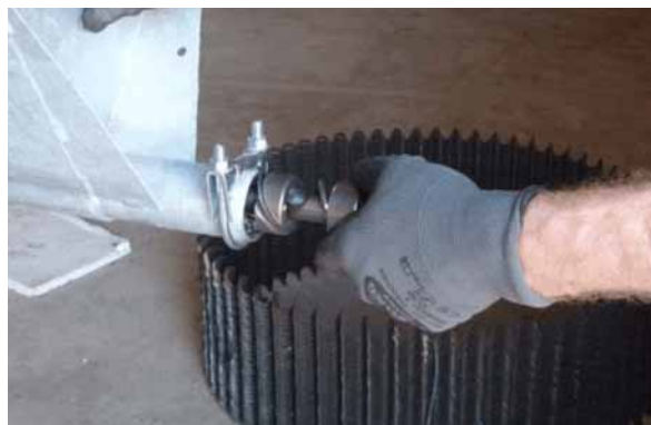
Рис. 6-3: Вытягивание вала натяжения
