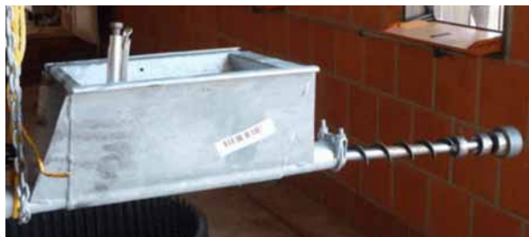
Рис. 6-4: Фиксация спирали зажимными щипцами
