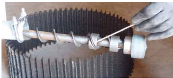
Рис. 6-5: Отделение спирали от вала натяжения
