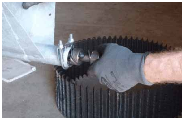
Рис. 6-8: Придерживание вала натяжения
