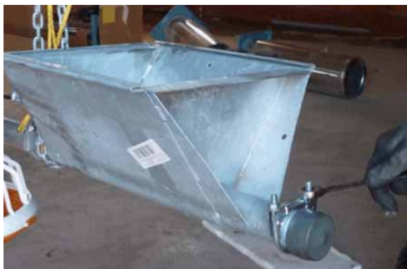
Рис. 6-9: Закрепление вала натяжения
